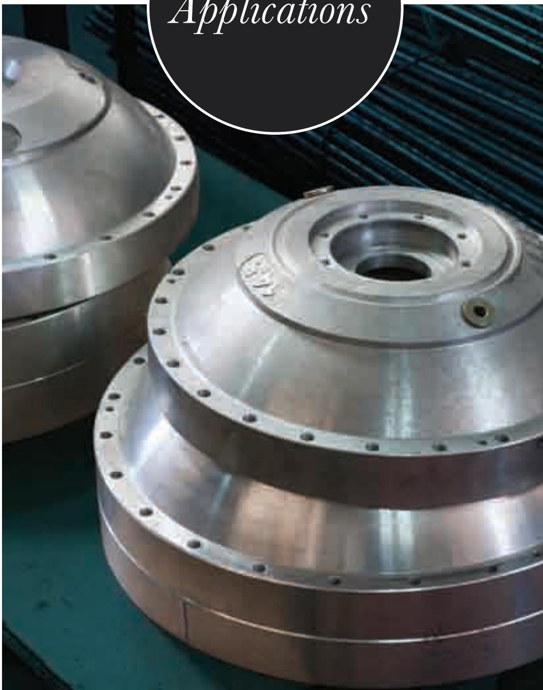
*Le coupleur hydraulique a contribué efficacement à la génération sur plusieurs applications de l'emploi de moteurs avec démarrage direct, les plus simples, sûrs et moins chers du marché.*
